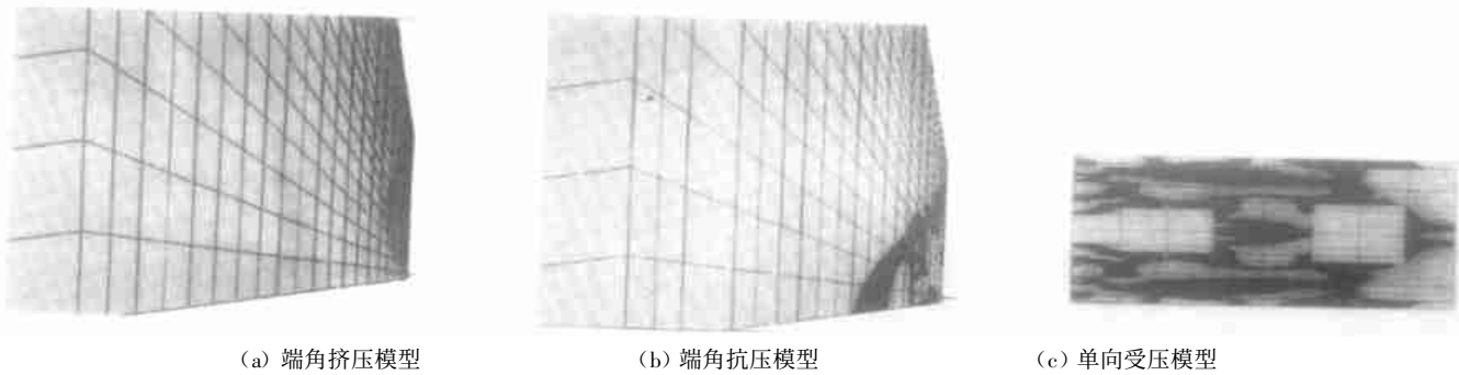
图 4 端角挤压破坏对比
